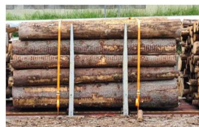
Bei Sattelung und glatter Rinde oder anderen Waggontypen als Ros, Rnooss-uz, Laaprs, Laars sind zwei Niederbindungen je Stoß erforderlich.
