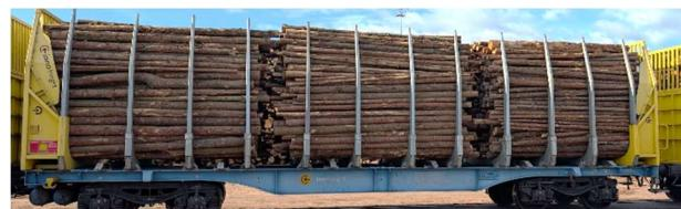
Nur eine Niederbindung (auch bei Sattelung) erforderlich, wenn Holz mit **rauer** Rinde auf Ros, Rnooss-uz, Laaprs, Laars verladen wird. Nur in AT im nationalen Verkehr erlaubt.
