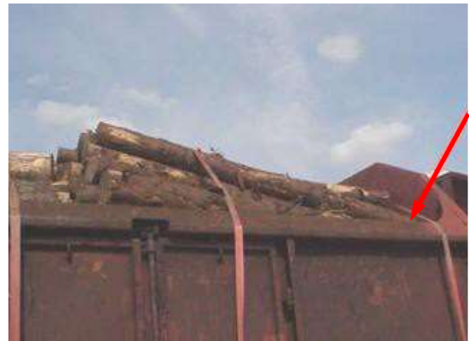
Die Niederbindung wirkt nicht auf jeden oberliegenden Stamm! Erhöhte Gefahr des Verrutschens der Ladung!
