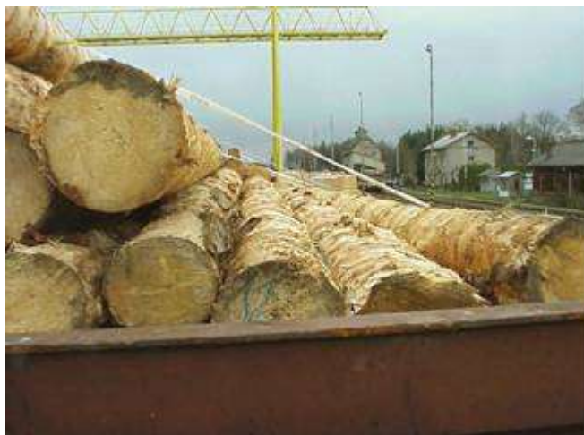
Die Niederbindung wirkt nicht auf jeden oberliegenden Stamm! Erhöhte Gefahr des Verrutschens der Ladung!
